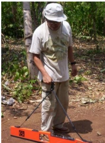
Figura 5. Dispositivo EM-38 de Geonics Inc. utilizado para la medición de la conductividad eléctrica aparente del subsuelo en modo dipolar vertical.
