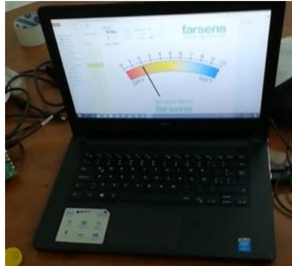
Fig.18: Experimento con tierra seca. Se visualiza un 20% de humedad
