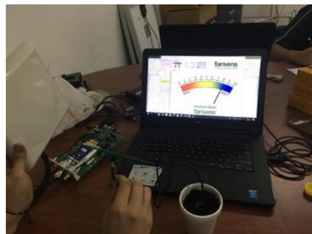
Fig.19: Experimento con tierra húmeda. Se visualiza un 80% de humedad
