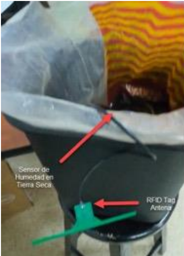
Fig.18: Experimento con tierra seca. Se visualiza un 20% de humedad
