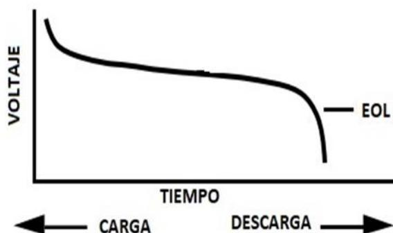
**Figura 1.** Curva característica de carga/descarga de una batería. Adaptada de (Simpson, 2007)
